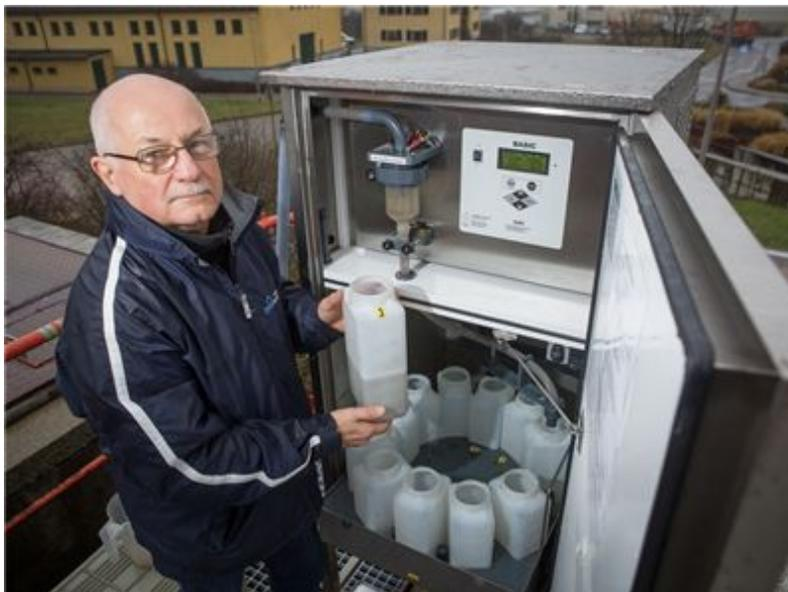
Auf der Spur der Drogen. Laborchef Norbert Lucke am Automaten, mit dem am Zulauf des Klärwerks Kaditz rund um die Uhr Abwasser-Proben genommen werden. Einige davon sind seit 2013 in einem Speziallabor auf Drogen untersucht worden.
